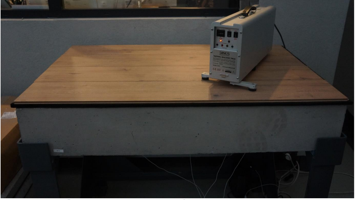
Şekil 4.2 Darbe Sesi Üreteci 1. Konumdayken Numune İle Beraber Deney Anı
