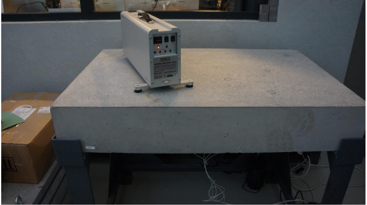
Şekil 4.1 Darbe Sesi Üreteci 2. Konumdayken Numune Yokken Deney Anı
