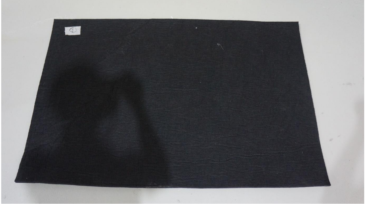
Şekil 2.1 9-10mm İzobozz Keçe Numune 1
