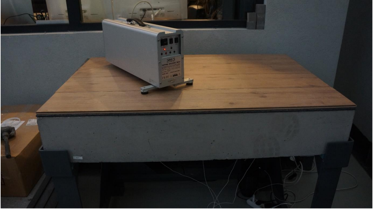
Şekil 4.3 Darbe Sesi Üreteci 2. Konumdayken Numune İle Beraber Deney Anı
