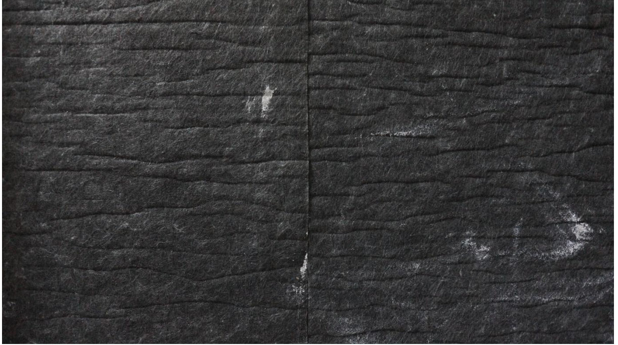
Şekil 3.9 İzobozz Polyester Elyaf 15mm Keçe Uygulaması Detayı
